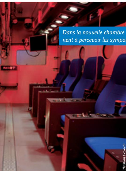
Dans la nouvelle chambre hypobare, les pilotes apprennent à percevoir les symptômes du manque d'oxygène.
